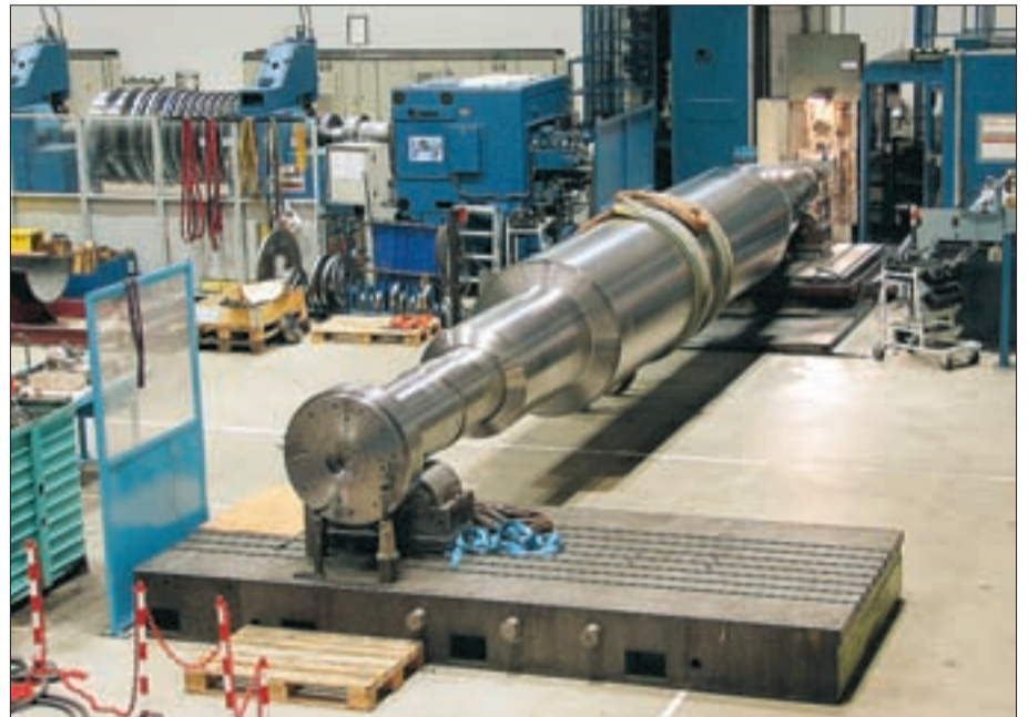
Alstoms TVO-rotor upplagd för långhålsbörning.
